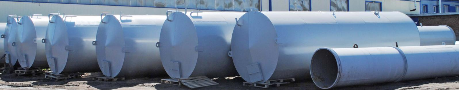
Водонапорная башня Рожновского (ВНБ) предназначена для регулирования расхода и напора воды в водонапорной сети, создания её запаса и выравнивания графика работы насосных станций. Также башни используются в системах противопожарного, производственного и хозяйственно-питьевого водоснабжения населенных мест, сельскохозяйственных комплексов и различных промышленных объектов.
