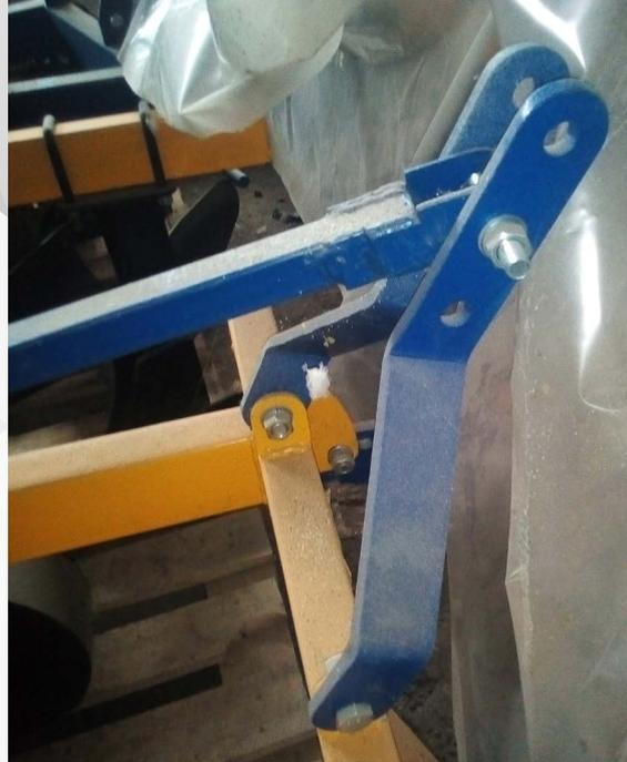
Плуг модульный универсальный ПМУ 3-20 предназначен для пахоты почв под зерновые и технические культуры на глубину до 20 см, не засоренных камнями, плитняком и другими препятствиями, с удельным сопротивлением почвы до 0,09 МПа (0,9 кг/см<sup>2</sup>) и твердостью до 4,0 МПа.
